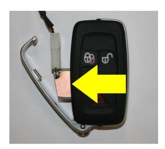
WHEN THE BATTERY TRAY IS IN THE KEY FOB, THE METAL TRIM CAN NOW BE SNAPPED CLOSED.
