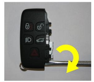
THERE IS A MARKED SLOT ON THE EXPOSED LOWER EDGE OF THE CASE, INSERT A SCREWDRIVER AND TWIST IT APART.
